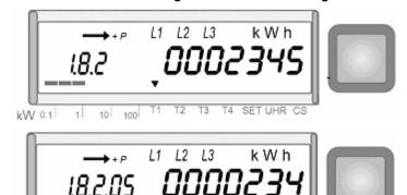
Drücken Sie ununterbrochen auf die Anzeigetaste bis Ihnen mit dem Anzeigecode 1.8.2 die Wirkenergie Schwachlast angezeigt wird.
