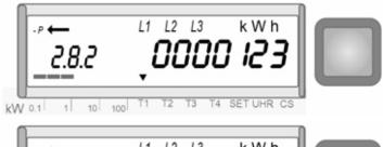
Drücken Sie ununterbrochen auf die **Anzeigetaste** bis Ihnen mit dem **Anzeigecode 2.8.2** die **Wirkenergie Schwachlast** angezeigt wird.
