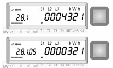
Drücken Sie ununterbrochen auf die **Anzeigetaste** bis Ihnen mit dem **Anzeigecode 2.8.1** die **Wirkenergie Normallast** angezeigt wird.
